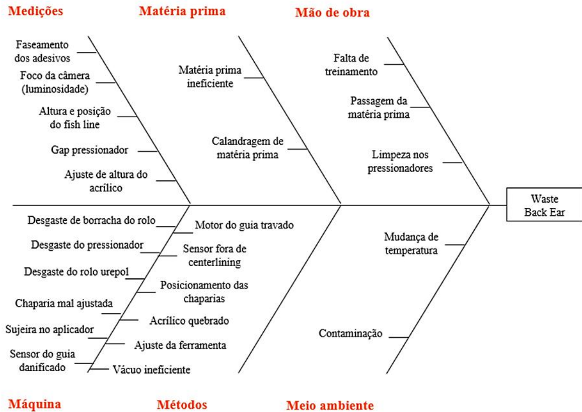
Fig. 4. Diagrama causa-efeito empregado para investigação do problema de waste back ear .
