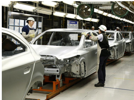
Figura 7 - Fim do processo E-coat [13].
