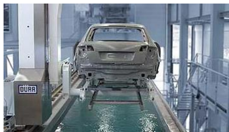
Figura 5 - Tanques de lavagem [9].
