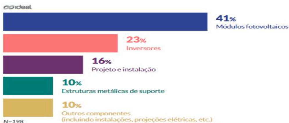
Figura 1 - Gráfico de composição do custo total da instalação de um sistema FV.
