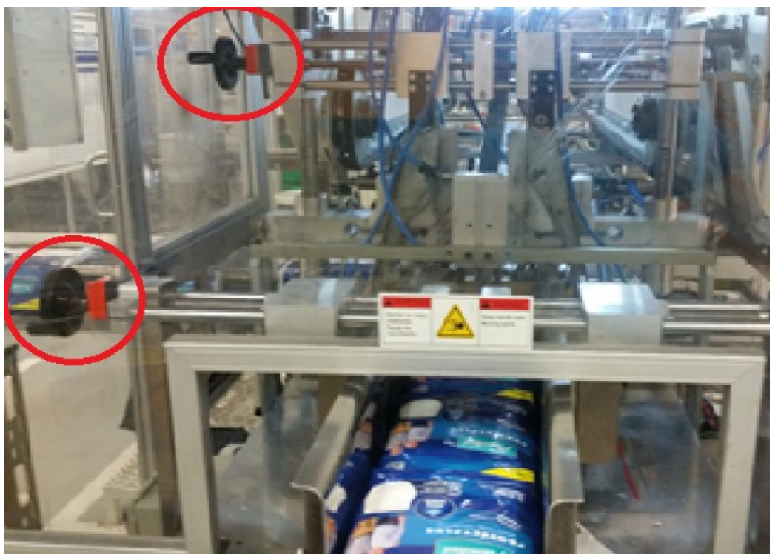
Imagem 06 - Embaladora, após aplicação do SMED. Fonte: Próprio Autor.
